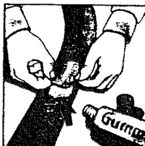
Schlauch aufpumpen und schadhafte Stelle suchen - notfalls unter Wasser. Stelle um den Schaden reinigen, aufrauen (Sandpapier) und Flicker sorgfältig aufkleben. Schlauch wieder unter Reifendecke drücken. Etwas aufpumpen (verhindert Faltenbildung), Decke über die Felge ziehen und Ventil festschrauben
